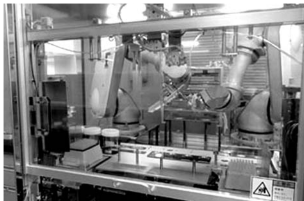
双腕ロボットシステム“CellPRO” (澁谷工業(株) ホームページより)
