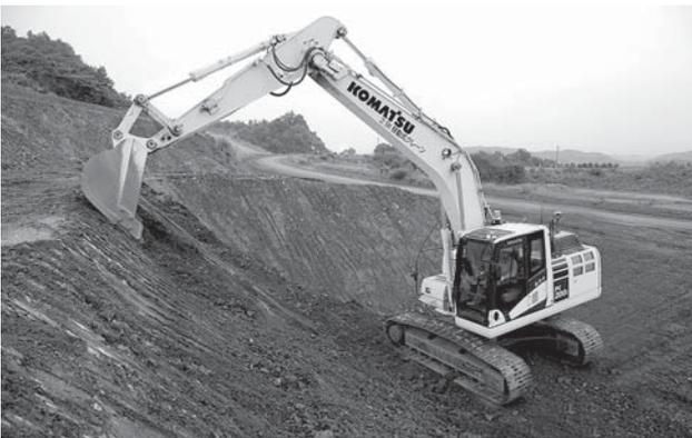
安全で生産性を大幅に向上させた「スマートコンストラクション」の現場で稼働するICT油圧ショベル
